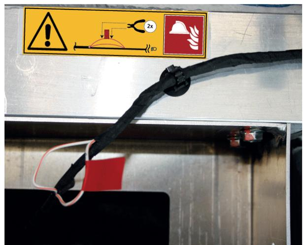
2) Durchtrennen Sie auf beiden Seiten des Fähnchens das Kabel und entnehmen Sie das herausgetrennte Kabelstück
